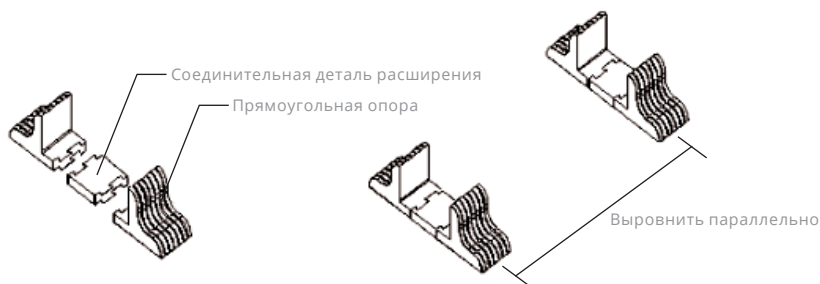
Рис. 3.2.4.2. Схема сборки опор
